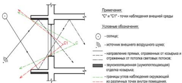
Рис. 7. Схема, показывающая влияние наружных СЗУ (козырьков) на поступление наружного света и звука в помещение и на степень визуального контакта из него с внешней средой
